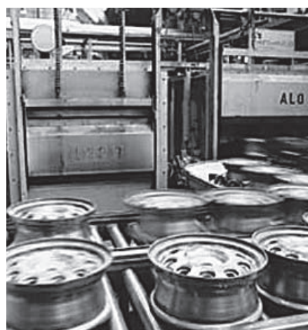
Horno de endurecimiento de aluminio con reguladores de proporción para protección de la falta de aire
